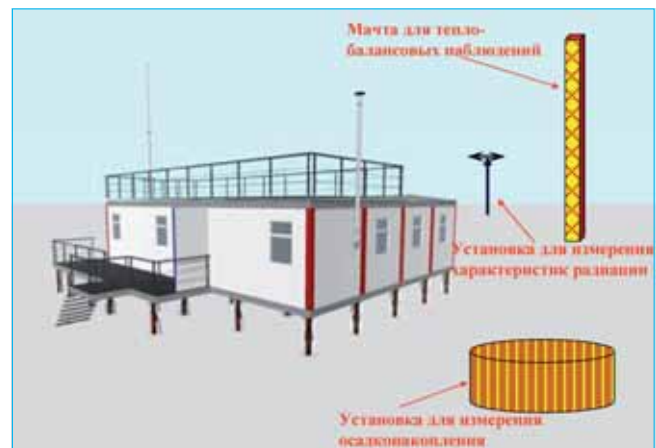
Главное здание будущей ГМО в Тикси (фото слева) и планируемый павильон для исследований по химии атмосферы (УЧМ) с установками для изучения процессов энерго-массообмена подстилающей поверхности и атмосферы (рисунок справа).
